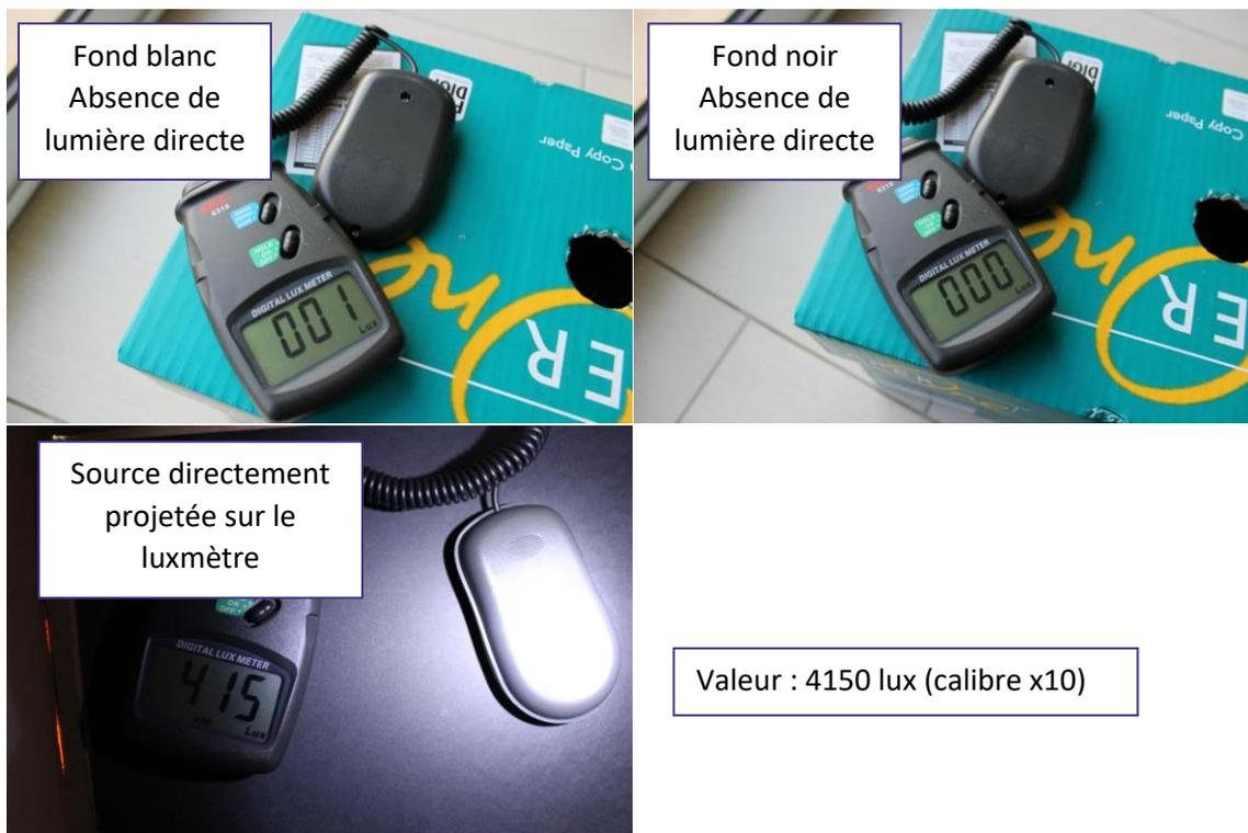
Conclusion de l'expérience : le capteur envoie un signal d'intensité constante, mais selon la couleur du support, une fraction différente de la lumière est absorbée ou réfléchi. Le récepteur reçoit donc plus ou moins de lumière selon la couleur. Cette information est transmise sous forme électrique au microcontrôleur. Cette valeur permet donc de « connaître » la couleur du support sous le châssis.
