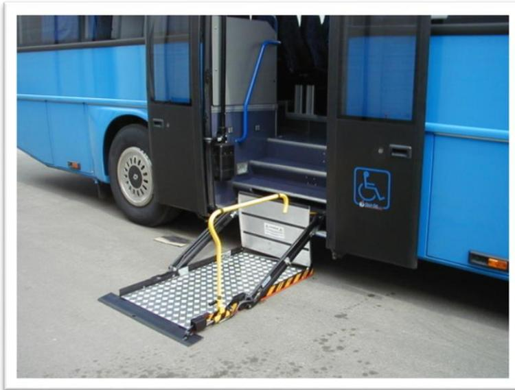
La rampe : solution répandue mais qui a l'inconvénient d'être longue à mettre en œuvre.
